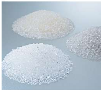
「TOYOBO GS Catalyst®」（写真手前）は他の触媒と比べ透明度が高い樹脂が合成されるという特徴がある
