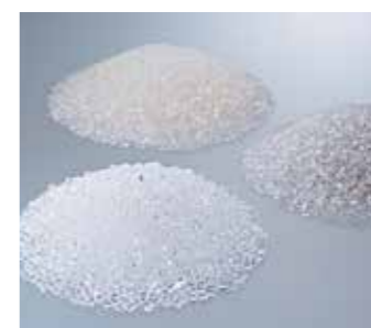
各種触媒で重合した ポリエステルレジン TOYOBO GS Catalyst®(前)、 アンチモン系触媒(右)、 チタン系触媒(後)
